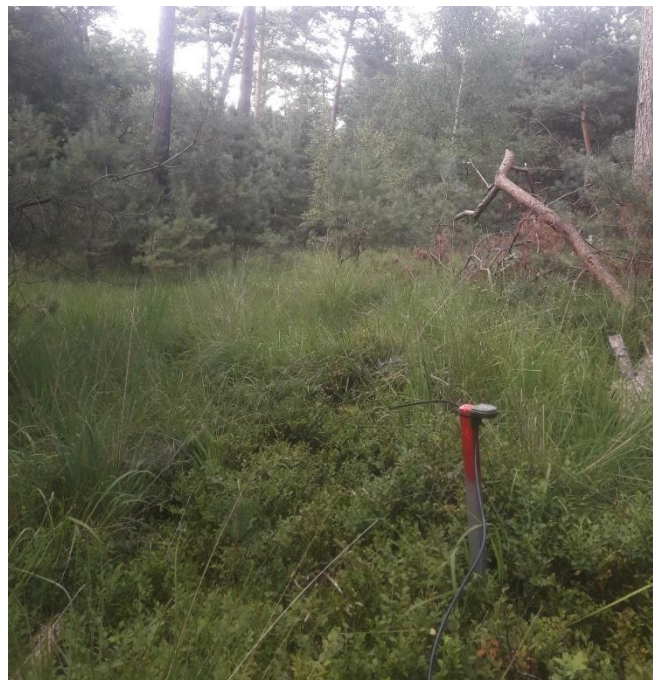
Figuur 14: Opstelling van de microfoon van de vleermuislogger bij Vierhouten. De microfoon is met een lange kabel verbonden aan de logger, om vrij te zijn van elektrische storing vanuit de logger.
